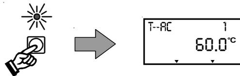
Este parámetro permite la regulación de la temperatura querida del agua sanitaria caliente.
