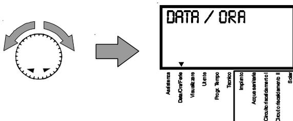
Per tornare al livello superiore **DATA / ORA** ruotare la manopla di navigazione/modifica (F) fino a visualizzare sul display **INDIETRO** quindi premere sul tasto di programmazione (C).
