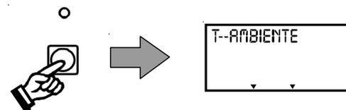
Para volver al nivel superior **Instalac**, girar la manopla de navegación/ modifica (F) hasta visualizar en la pantalla **Detrás**, entonces pulsar el botón de programación (C).
